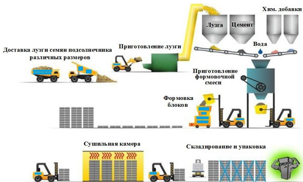
Рисуно15. Технология получения конструкционно-теплоизоляционного бетона.
