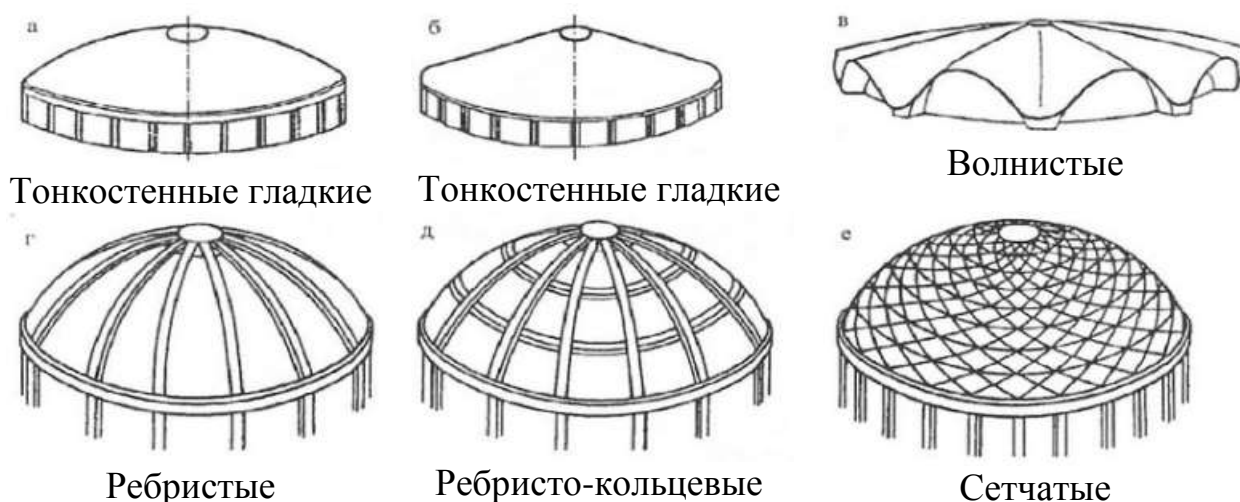
Рисунок 2 – Современные купольные конструкции
