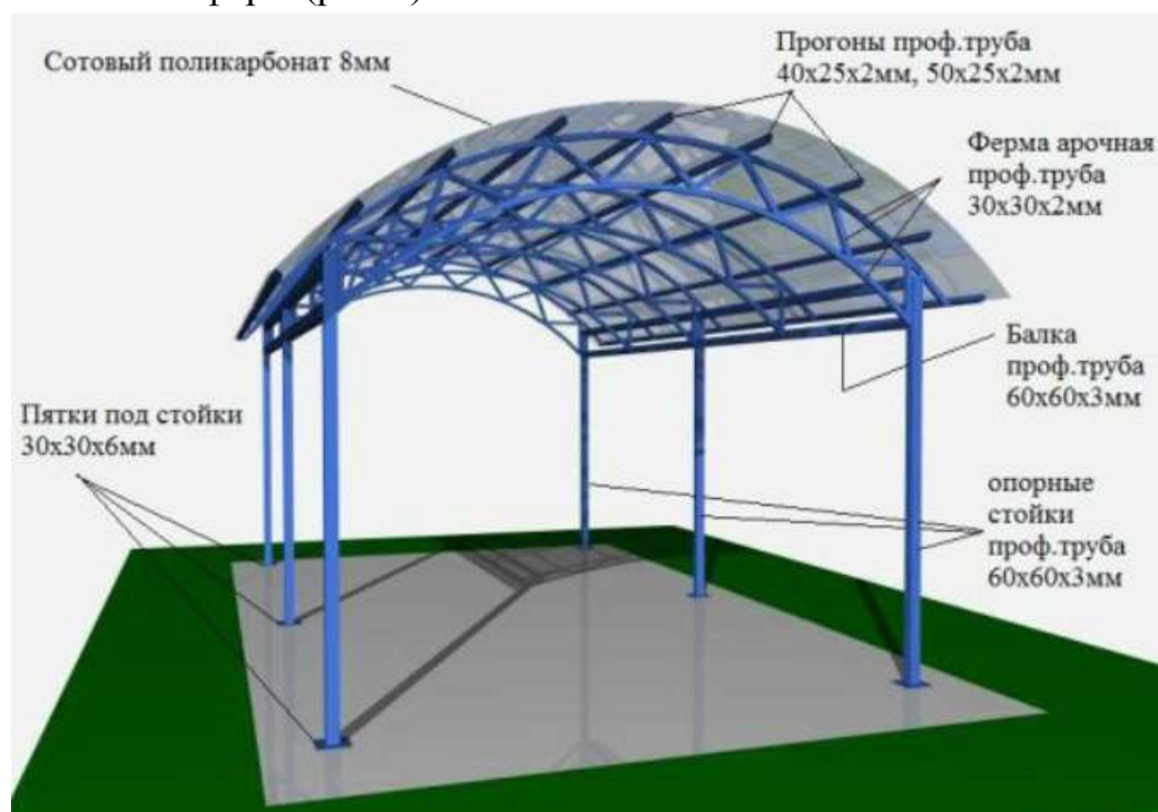
Рисунок 1 –Перекрытие арочного типа
