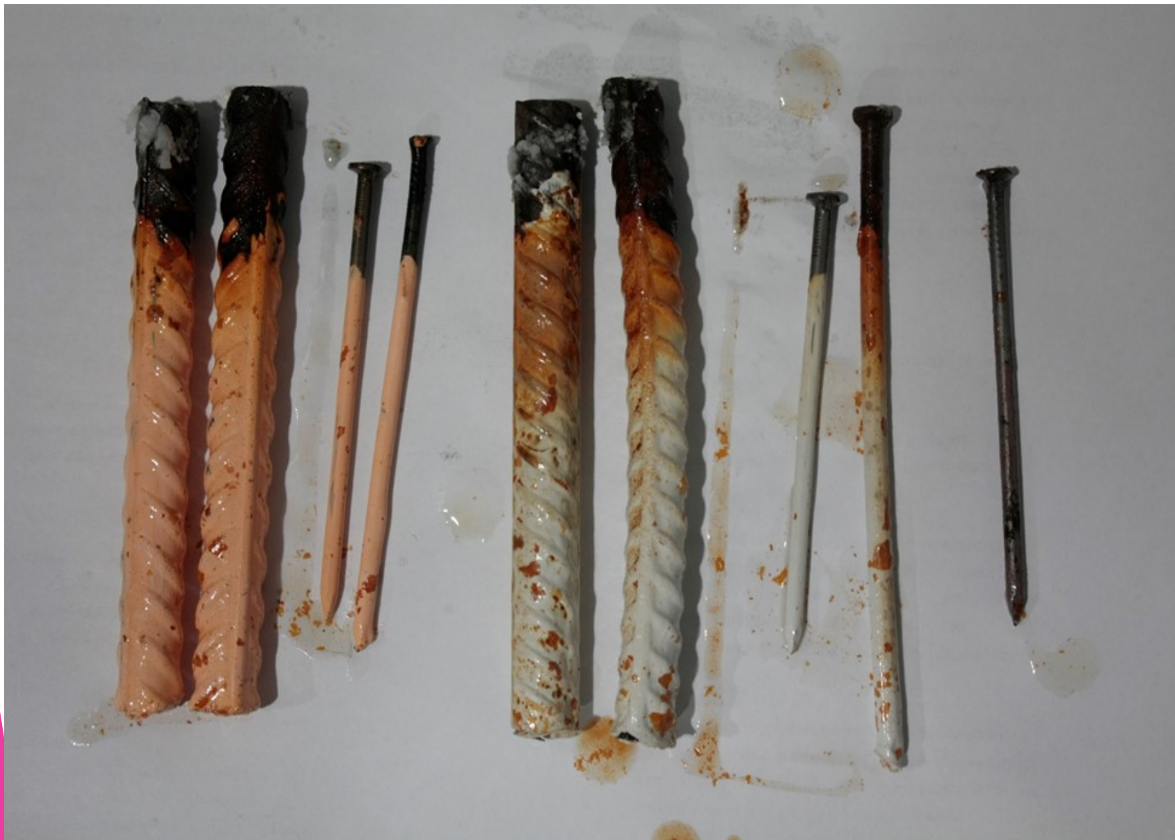
Изображение № 6. Образцы, помещенные в раствор соли на 7 дней
