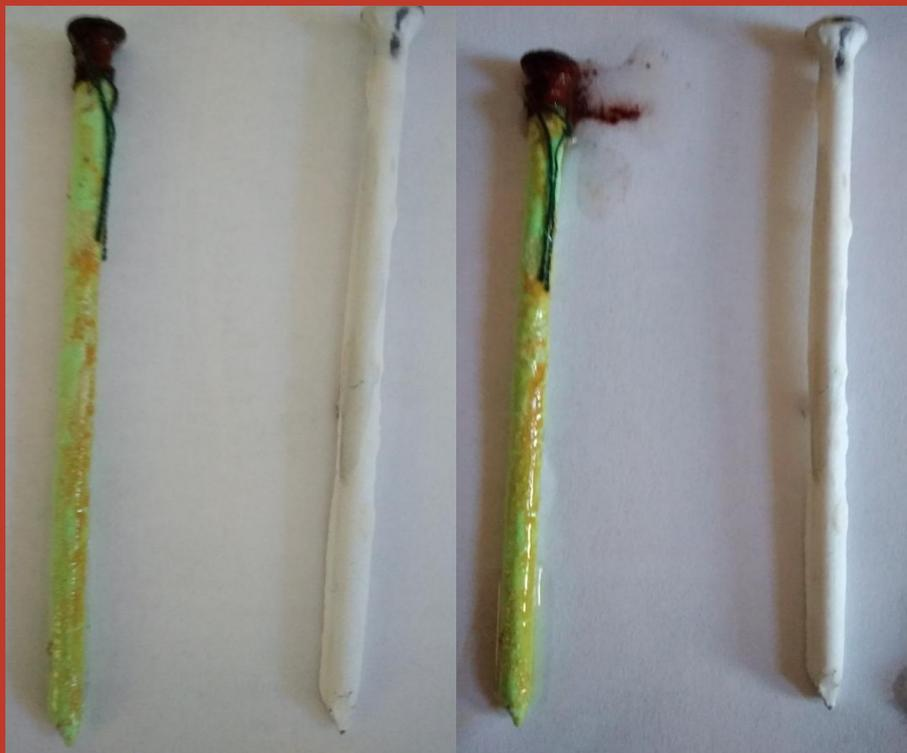
60% площади гвоздя покрылось коррозией. Сколов, трещин, разрушений нет. Цвет покрытия местами изменился на оранжевый(из-за коррозии). Покрытие скукожилось сильнее.
