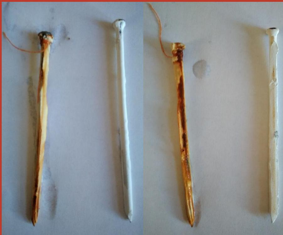
**50% площади гвоздя покрылось коррозией. По всей поверхности гвоздя покрытие начинает разрушаться. Цвет сменился с светло-желтого на желтый, коричневый.**
