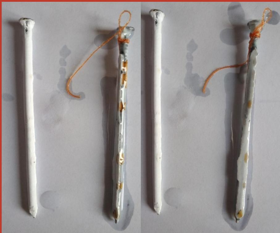
30% площади гвоздя покрылось коррозией. Начало разрушения покрытия можно наблюдать под шапкой гвоздя, скол имеется на конце гвоздя. Цвет не изменился.
