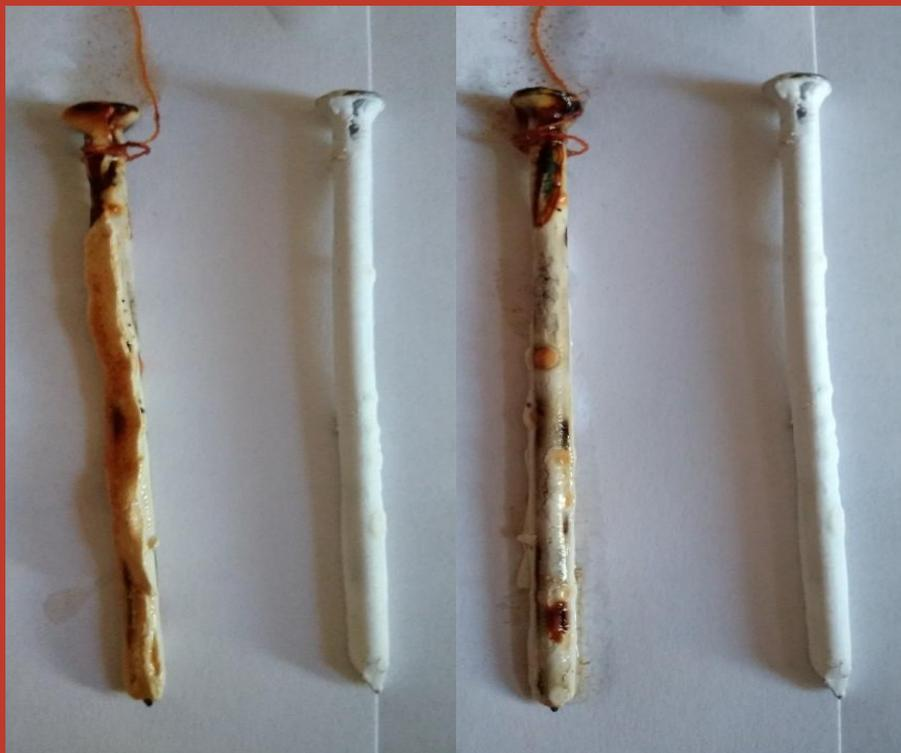
25% площади гвоздя покрылось коррозией. Покрытие под шапочкой гвоздя разрушилось. Появился сколы, трещины. Цвет гвоздя остался светло-коричневым, местами черным.
